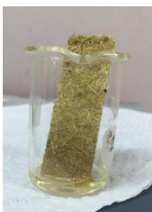
รูปภาพที่ 3.4 การทดสอบการดูดซับมันของกระดาษ
